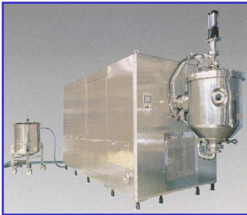
ゴム栓洗淨装置 （東亜工業へ事業譲渡）
